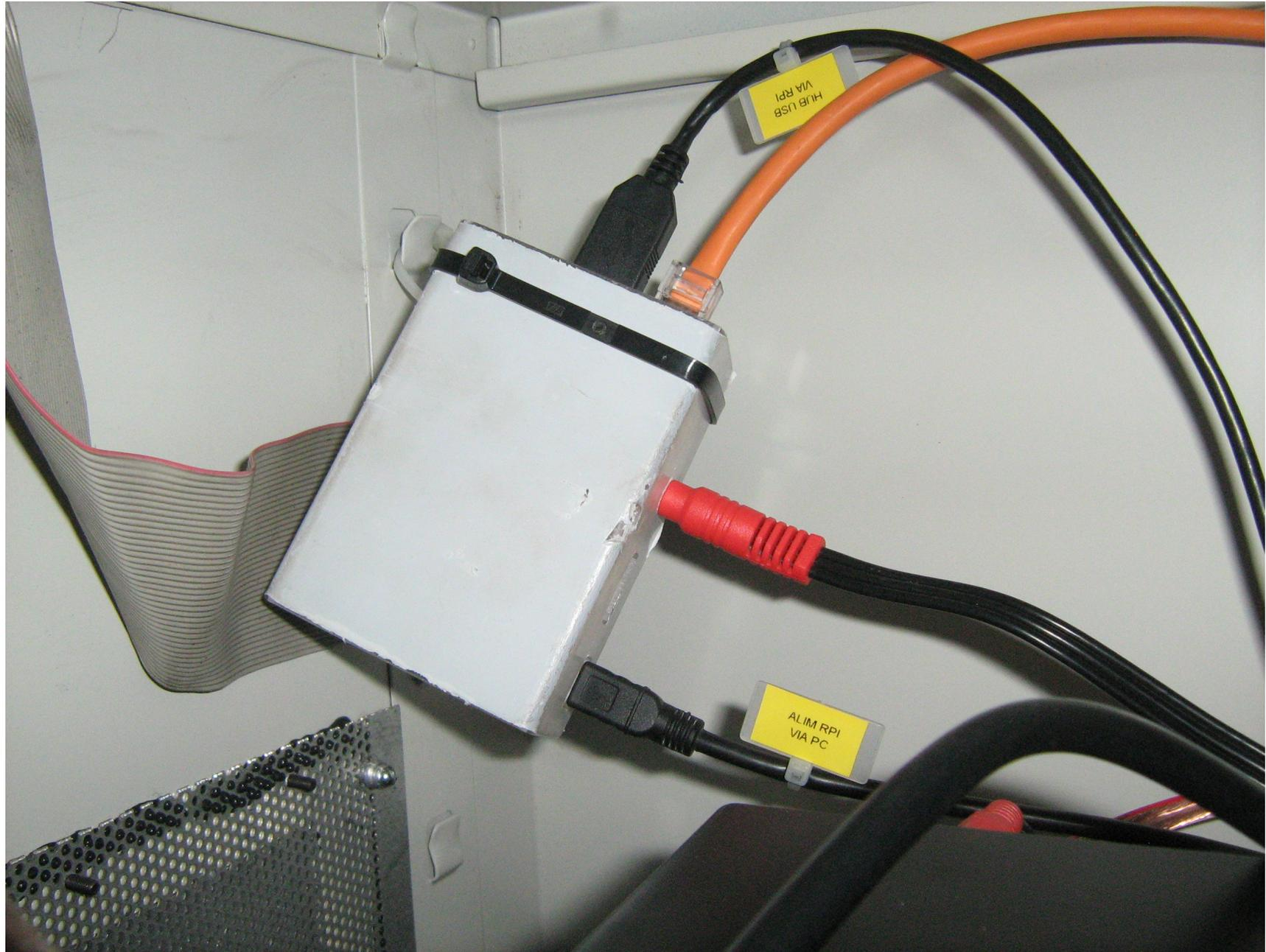
Toute la logique de ON0CTV tourne autour d'un Raspberry PI B+, l'OS utilisé est un raspbian classique, ce système est flexible, bon marché et relativement performant.
